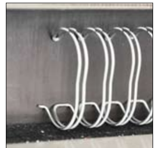
Magnetleiste zur Unterstützung beim Bindevorgang
